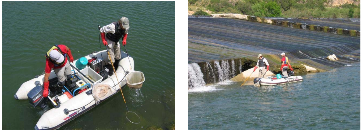
Fig. 5. Muestreo de peces: pesca eléctrica desde embarcación.
