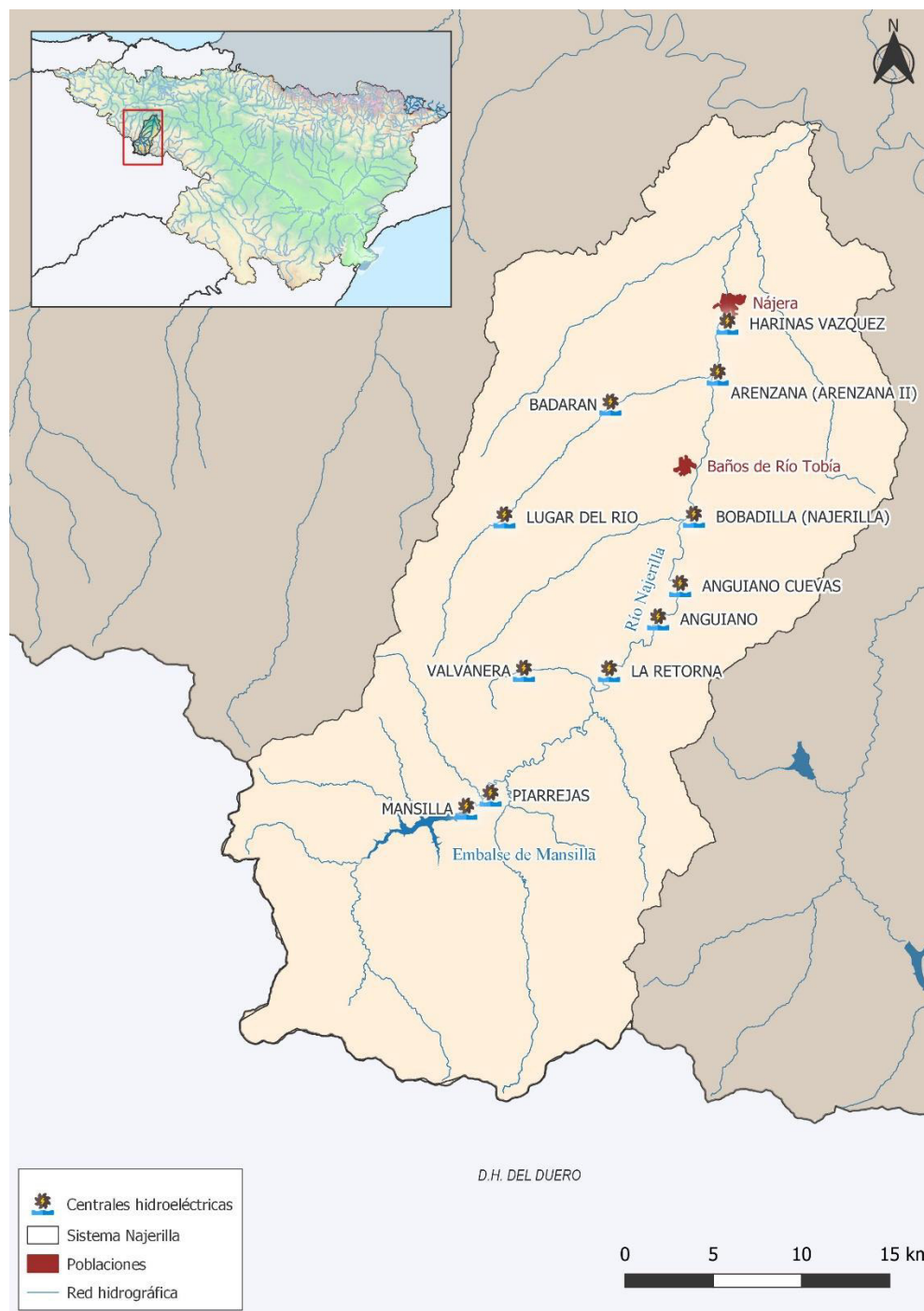
Figura 5. Centrales hidroeléctricas en el Sistema Najerilla
